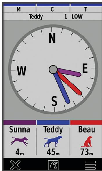
С помощью компаса для отслеживания собаки можно следить за направлением движения и расстоянием до собаки, транспортного средства и любого сопряженного устройства. Компас для отслеживания собаки также показывает ее состояние, например бег или стойку ([Значки состояния собаки, стр. 13](#)). Цвет указателя совпадает с цветом трека.
